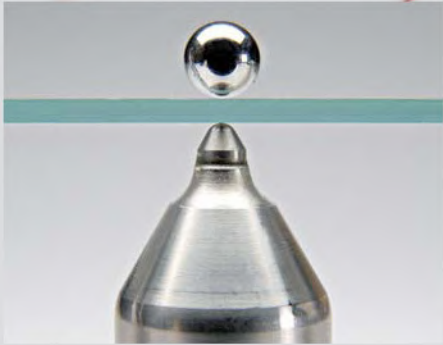
Detalle de medición en una muestra de vidrio con bola de acero de 2,5mm.
